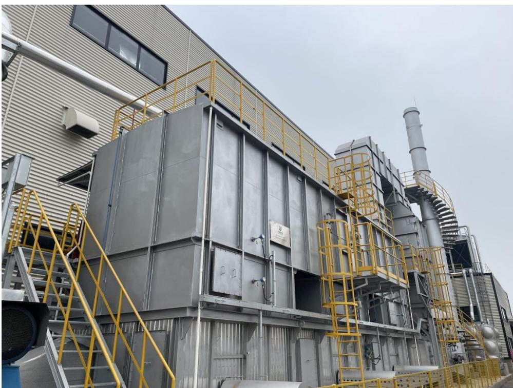
**3号RTO炉+18米高排气筒DA003 ( 4号车间)**
