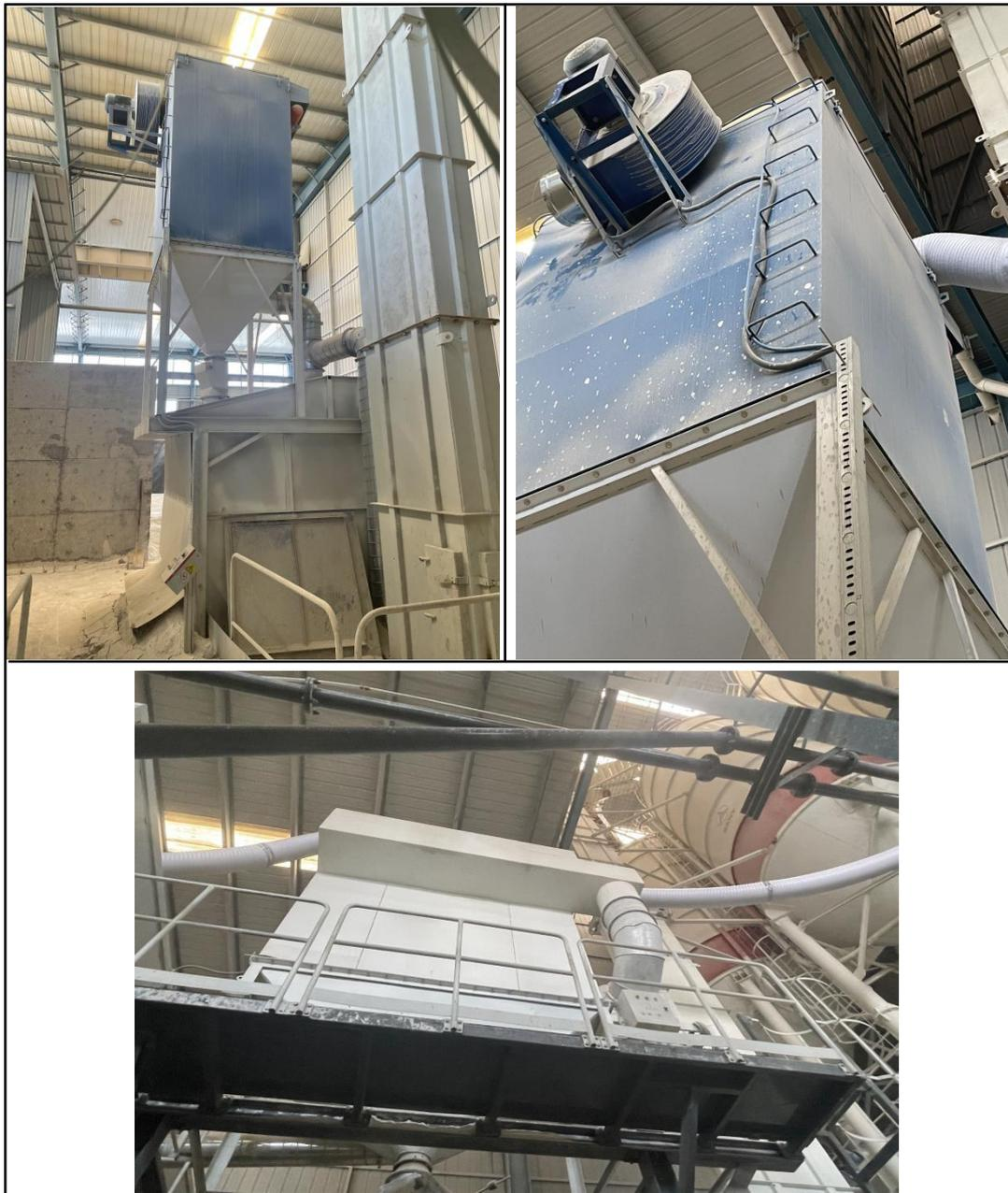
破碎工段布袋除尘装置+收集管道装置
