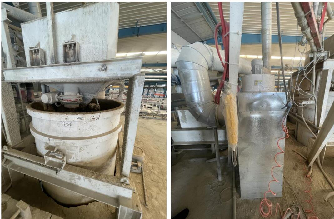
搅拌工段布袋除尘装置+收集管道装置
