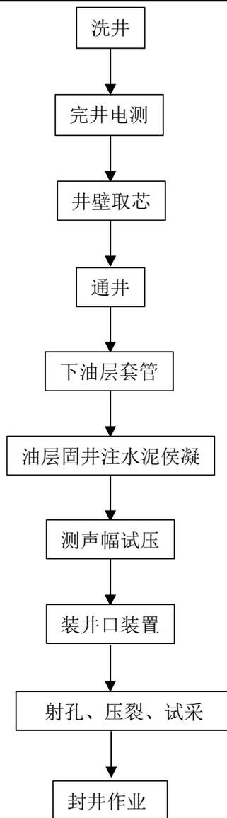
**图 2-4 完井工程工艺流程图**
