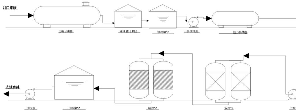
**图 5-1 沙埝联合站生产工艺流程图**
