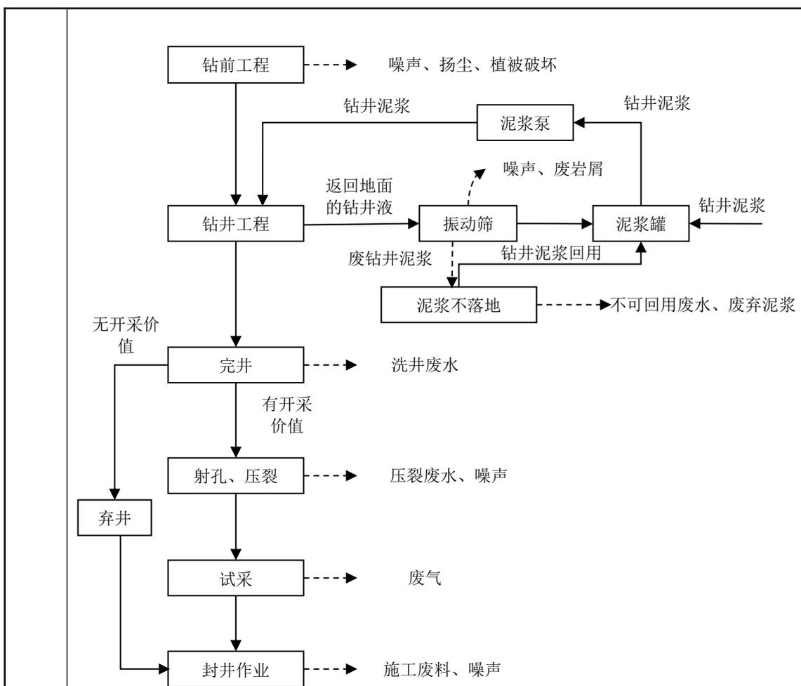
图 2-2 施工工艺及产污流程图
