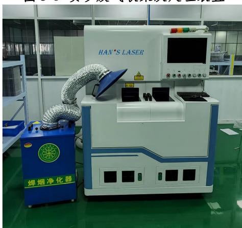
图 3-7 移动式烟尘净化器
