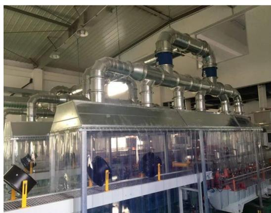
造粒废气收集装置
