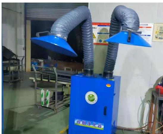
移动式焊烟净化装置
