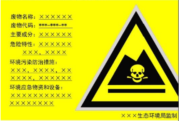
贮存设施内部分区警示标志牌：
