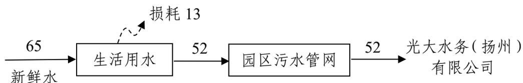
图 2-1 本项目水平衡图 (t/a)
