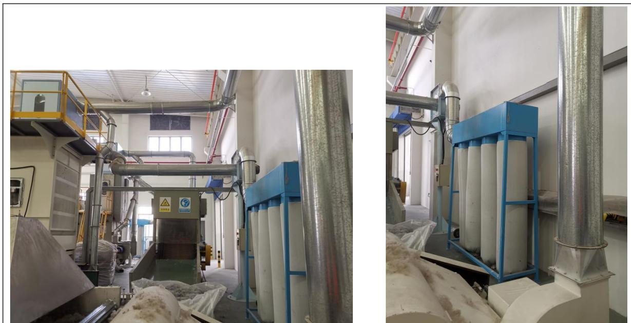
图 3-5 开松粉尘配套凝棉器+积尘袋处理
