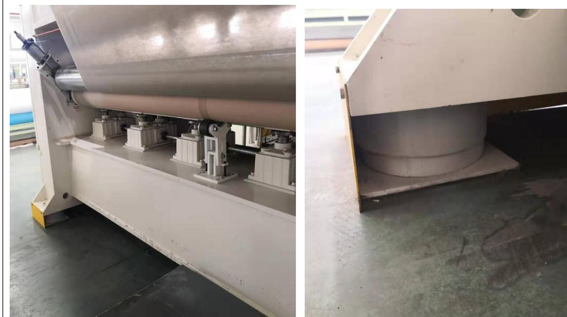
图3-6 噪声设备防护减震垫图
