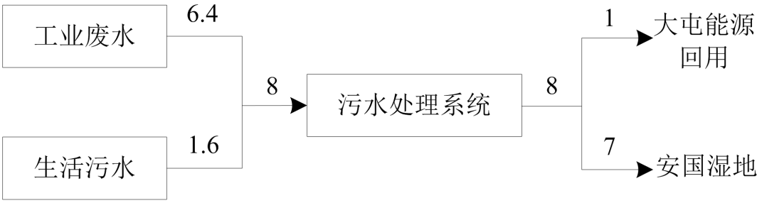
图 4.5-3 全厂水平衡图 单位：万吨/日
