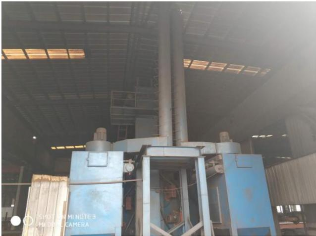
图 10-3 排气筒及除尘装置
