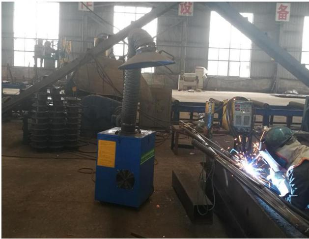
图 10-1 移动式焊接烟尘净化器
